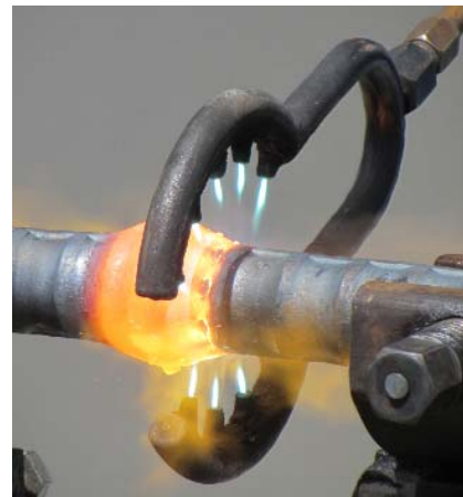
写真2 2014年度 関東支部材料施工専門委員会夏期研修会(天然ガス圧接工法の実演)
