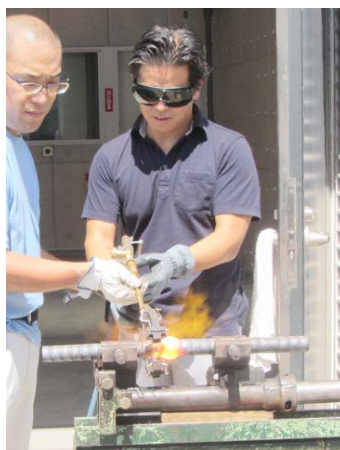
写真2 2014年度 関東支部材料施工専門委員会夏期研修会(天然ガス圧接工法の実演)
