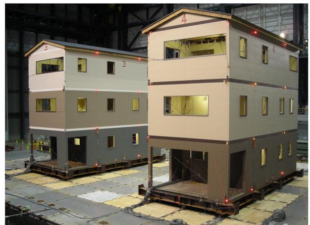
図 1. 木造実大振動台実験<sup>\*2)</sup>
