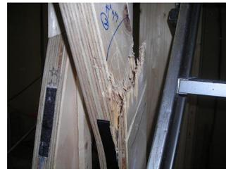
図 9. 筋かい交差部の座屈破壊
