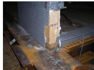
図 11. ホールダウン金物の脱落
