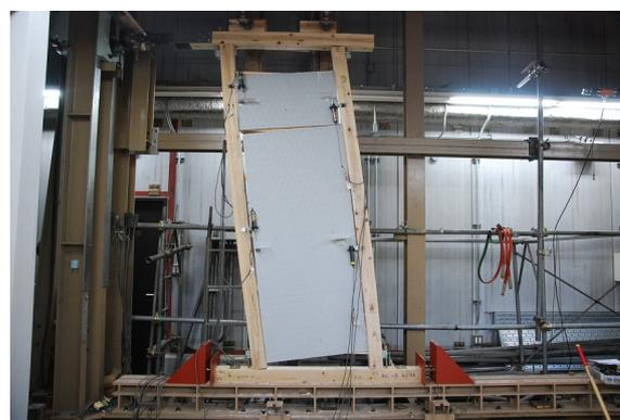
図17. ラスボード真壁仕様試験体
