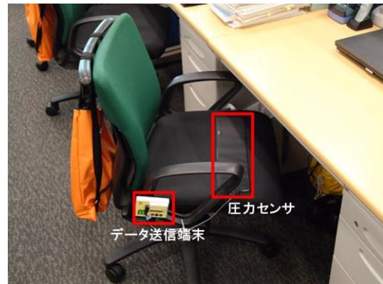
図6. 着座センサの設置状況
