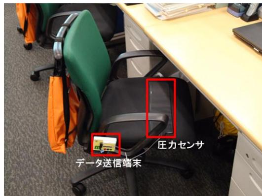
図6. 着座センサの設置状況
