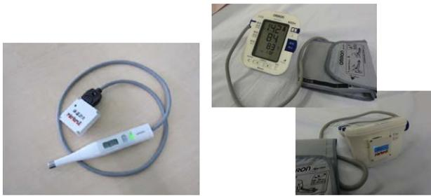
図2 位置計測機能を備えたバイタル計測機器
