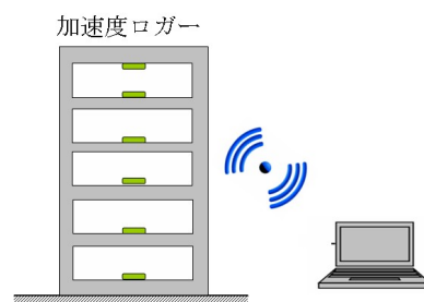
図 2.5 加速度ロガー配置とデータ通信の概要
