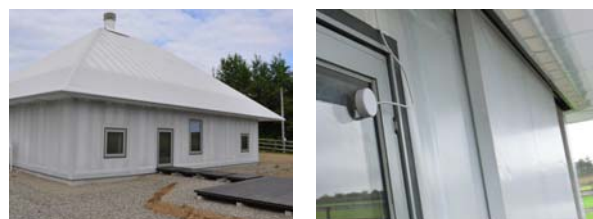
写真1 大樹町の寒冷地実験住宅(MEMU)外観と窓面に設置された温度センサ
