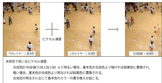
図2：ピクセル差分の抽出方法
