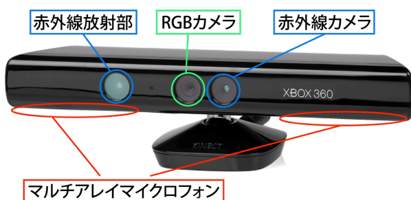
図1. Kinect に搭載されたセンサー
