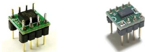
(a) 加速度センサ A (b) 加速度センサ B
