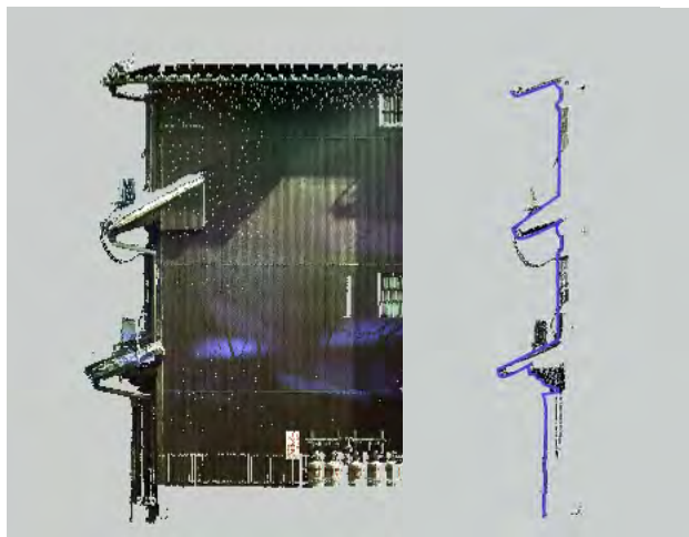
図3 金波楼の点群データ(左)と断面図(右)
