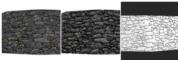
図 3. 石垣モデル (左 : 通常の平面ポリゴンにテクスチャマッピングしたもの ; 中 : ポリゴン化した自然石にテクスチャマッピングしたもの ; 右 : 自然石のポリゴン化)
