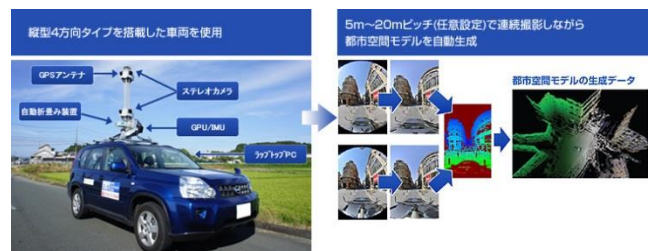
図3 3Dmにおける車両搭載型写真計測技術の概要
