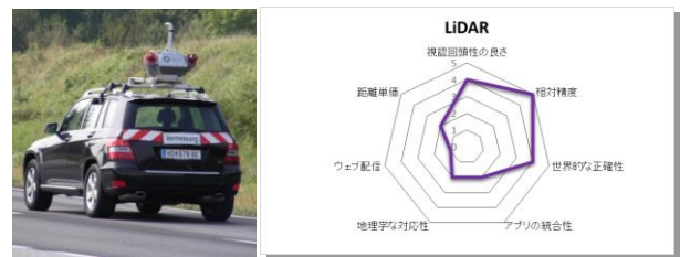
図7 LiDAR系車載型情報収集システム
