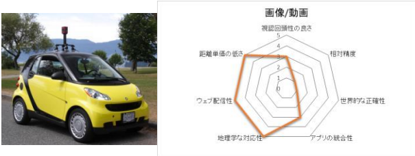
図6 画像/動画系車載型情報収集システム
