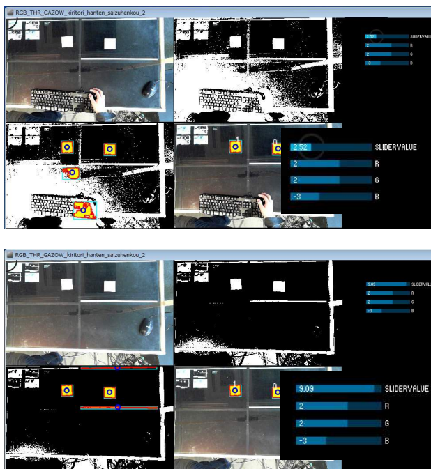
図 4 付箋検知の確認画面としきい値の調整 二値化のしきい値：低(上)高(下)
