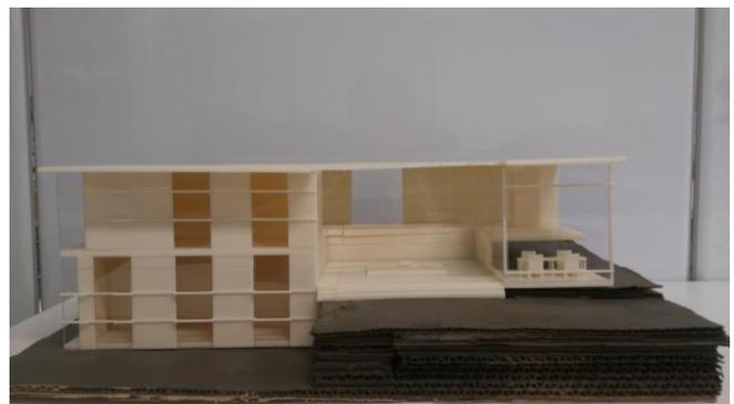
図 14 : 3D プリンターによる模型作製 (構造体のみ)
