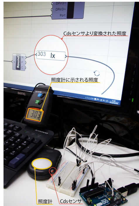
図 4. 電気抵抗値-照度変換式作成の様子
