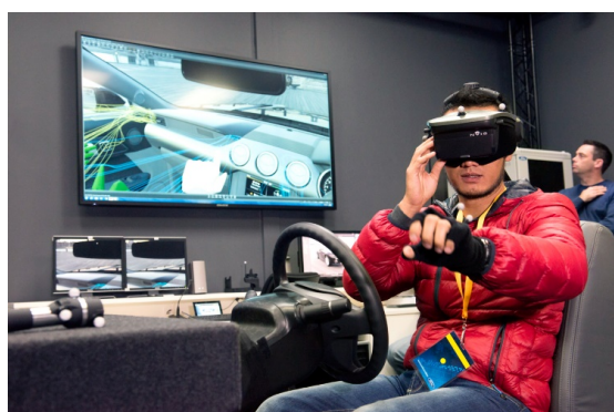
写真 2 米フォード社の「FiVE」で用いているヘッドマウントディスプレイ
