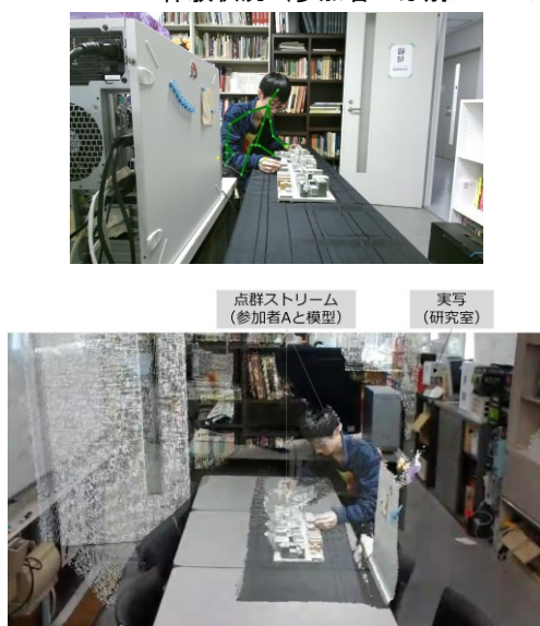
図 3. PcsMR-1: 画面キャプチャ (上: Kinect が取得した RGB-D 画像 [反転状態]; 下: HoloLens 画面)
