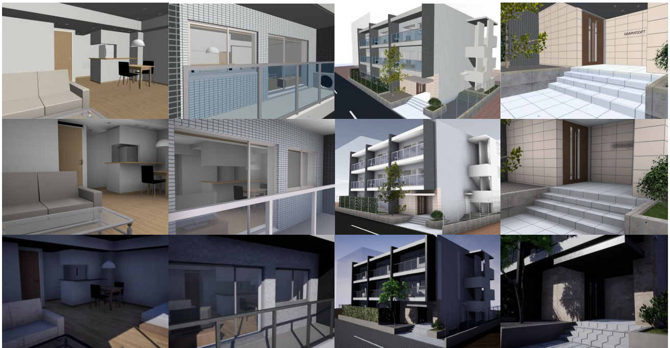
図8 ArchiCAD(上段)と BIMx(中段)と UE4(下段)での描画の違い
