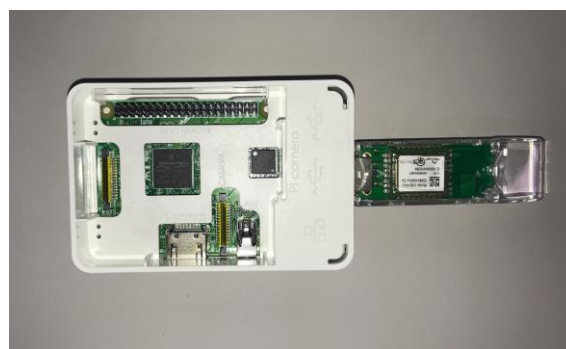
図-3 受信ゲートウェイ (Raspberry pi)
