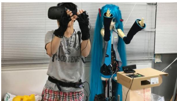
図-13 人とロボットとの動きの同期
