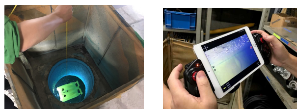
図12 水中ドローン試験運用状況
