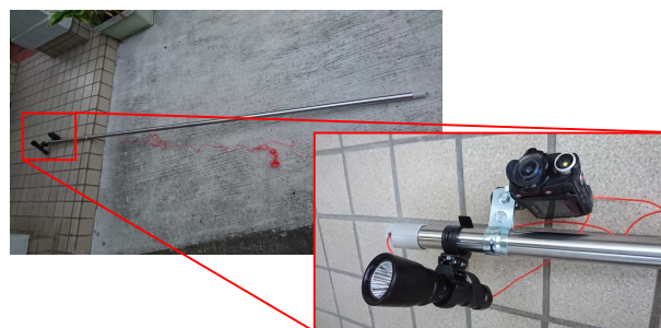
図11 現行の蓄熱槽内撮影器具
