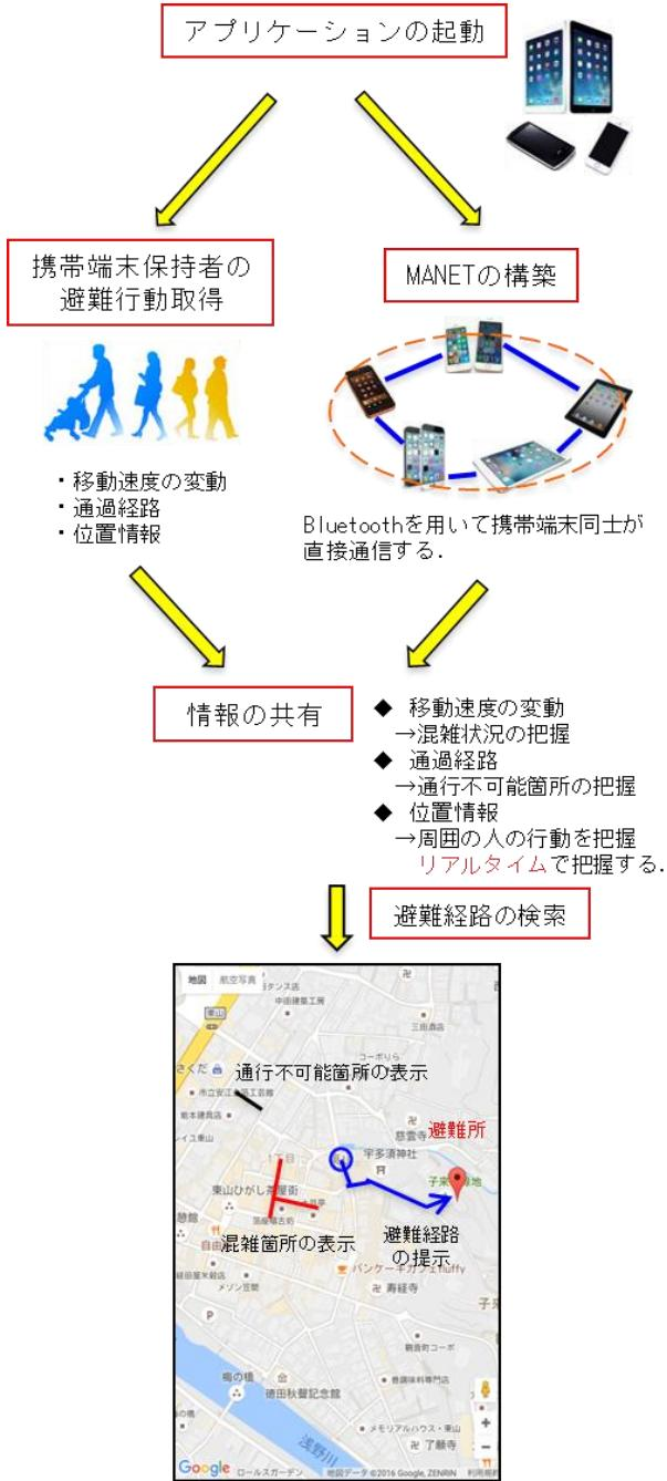
図-1 EMSS の仕組み
