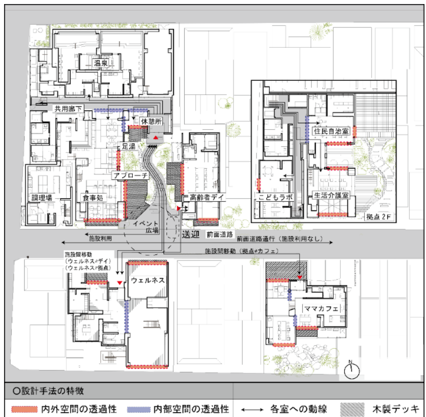
図3：輪島 KABULET 各施設の配置図と建築設計の特徴
