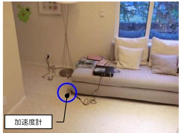
写真.2 測定機器設置状況
