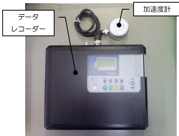
写真.1 加速度計（水平2成分・鉛直1成分）及びデータレコーダー
