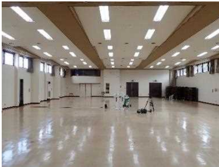
トレーサーガス(CO 2 )による換気量測定
