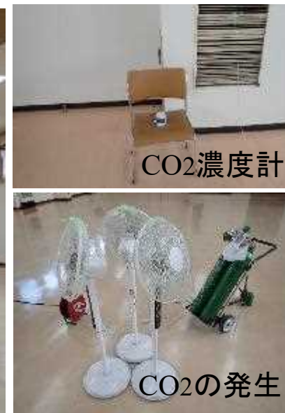
トレーサーガス(CO 2 )による換気量測定
