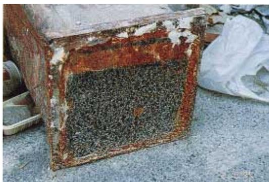
写真 CB1.26.1 1階柱頭ダイアフラムの破面
