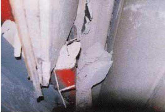
写真 CL2.3.1 柱継手溶接部の破断面
