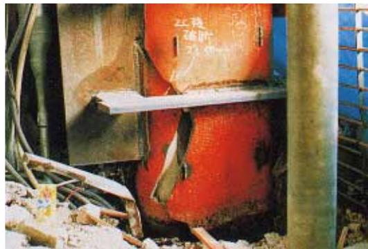
写真 CL1.3.4 材軸方向に進展した破面
