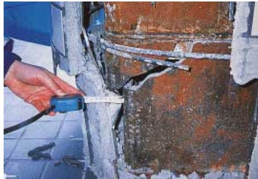
写真 C2.1.4.3 柱母材の破断
