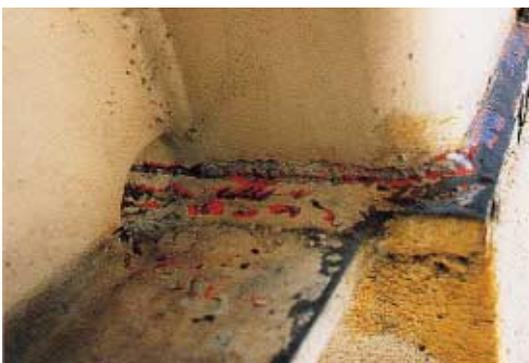
写真 CB1.38.2 溶接部の亀裂
