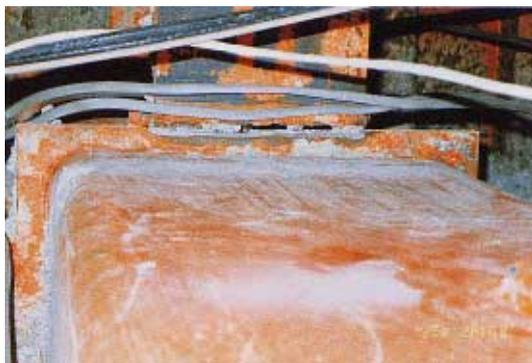
写真 CB1.3.2 ダイアフラム側熱影響部の破断
