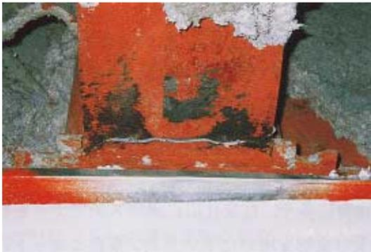
写真 CB1.1.1 下フランジの全面降伏後脆性破断
