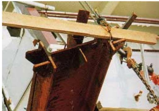
写真 BS2.1.2 すみ肉溶接部が破断した柱脚
