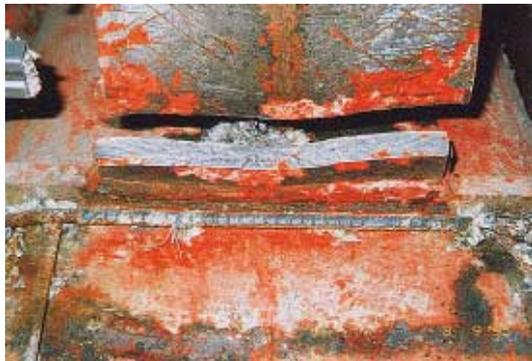
写真 CB1.6.2 下フランジの全面降伏後脆性破面
