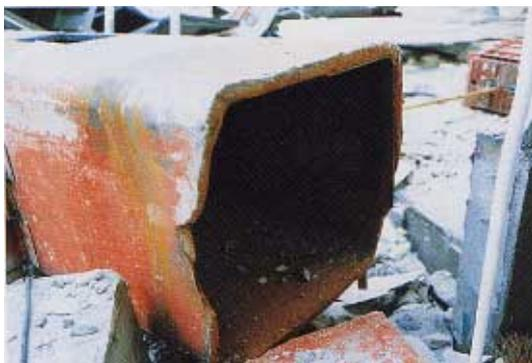
写真 CB1.21.2 柱の破断面(母材の一部も破断)
