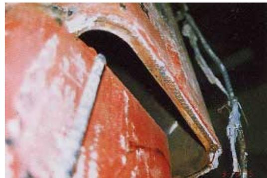
写真 CL2.1.3 破断面と裏当金
