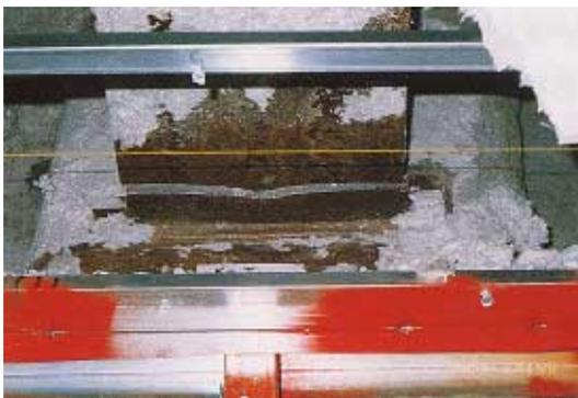
写真 CB1.1.2 下フランジの全面降伏後脆性破断
