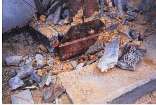
写真 CL4.8.2 柱脚アンカーボルトの破断
