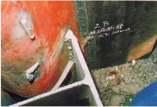
写真 CL1.3.2 写真 CL1.3.1 の輪切り状の破面
