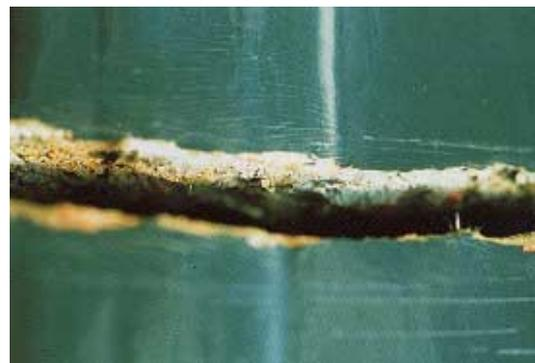
写真 CL3.1.3 弦材シーム溶接部破面近傍の塑性変形の痕跡
