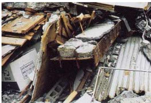
写真 BS2.5.1 ベースプレートと柱の溶接部の破断
