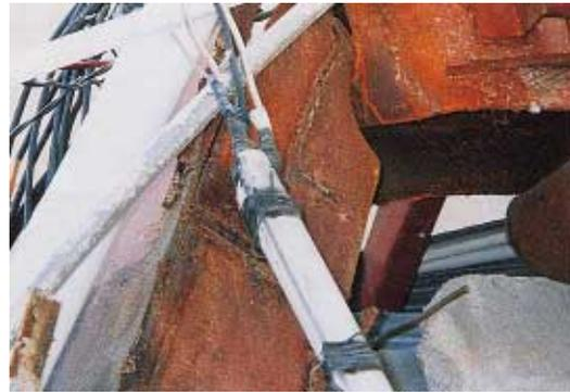
写真 BS3.3.2 梁端仕口の破断
