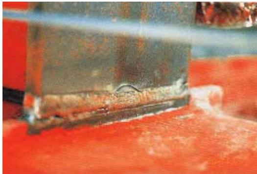
写真 CB1.12.1 梁フランジの破断
