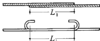
解図 16.12 重ね継手の長さの測り方 10)
