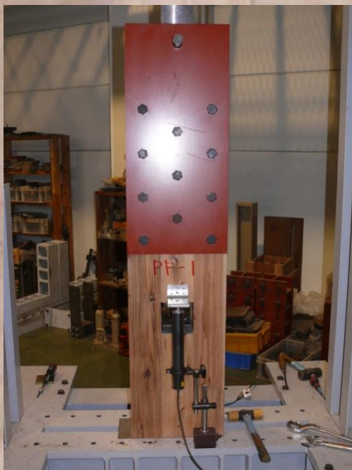
引きボルトの引張試験
