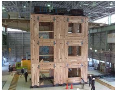
クロス・ラミネイテッド・ティンバー3階建て実大試験体の 振動実験 (2012 国土技術政策総合試験所)
