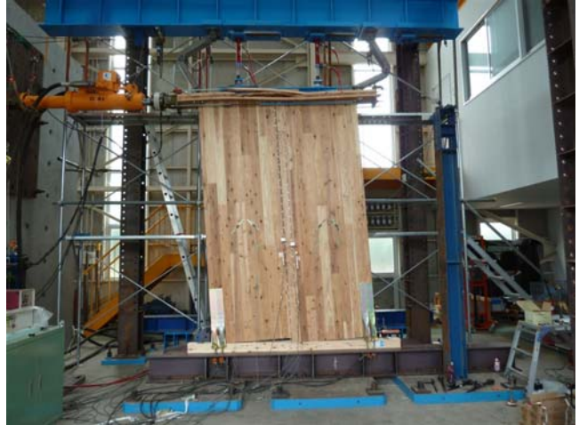
幅2m高さ3m 厚さ90mm CLT壁パネルの面内せん断試験
