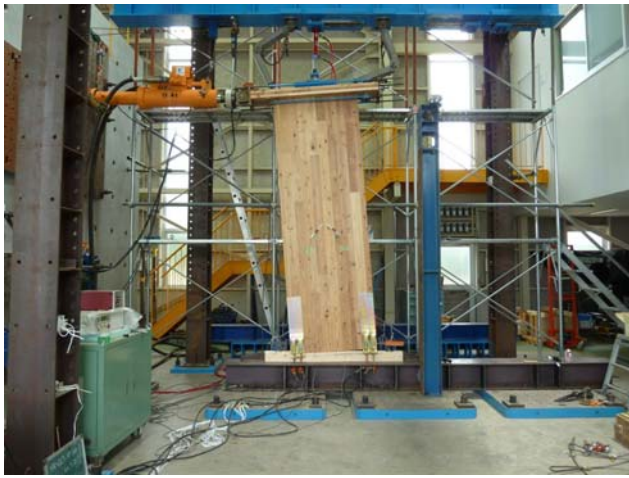
幅1m高さ3m 厚さ90mm CLT壁パネルの面内せん断試験
