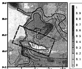
図13: 図6の2つの地下構造モデルを用いたシミュレーションによる関東平野の包絡波形の差の分布。(山田・山中, 2002)。
