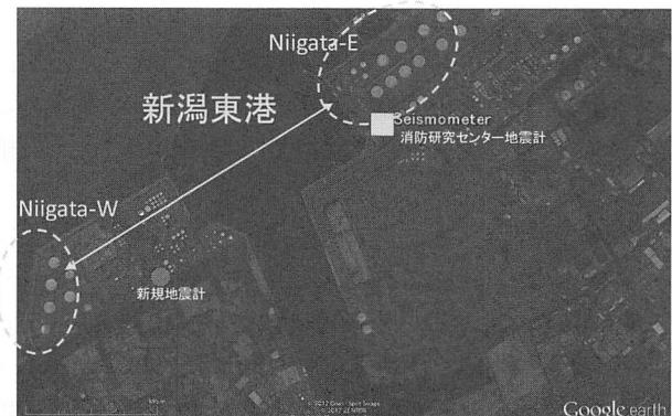
図 19 新潟県新発田石油コンビナート特別防災区域 Niigata-E と Niigata-W との距離は東港を挟んで約 2km、■は消防研究センター設置の地震計、●は新たに設置された地震計位置
