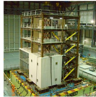
図 11 実大 5 層鉄骨造制振建物実験<sup>8)</sup>
