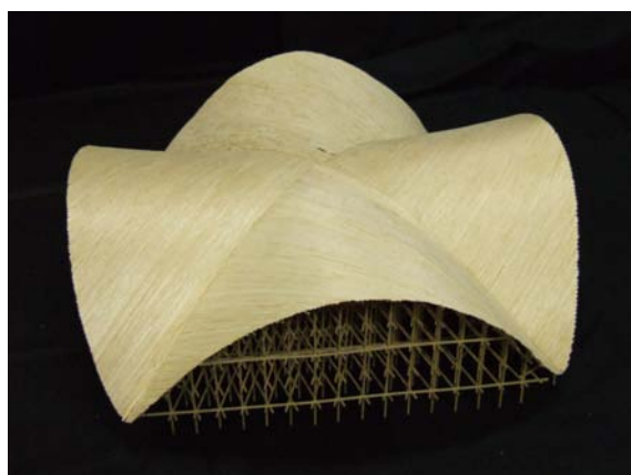
図1 鞍型交差HPシェル模型
