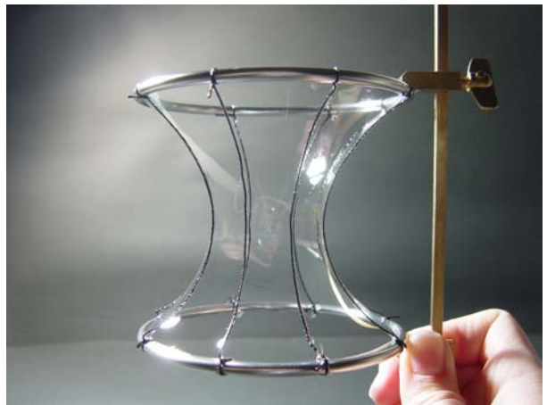
写真 4 : ケーブル付帯条件付きの極小曲面(h=10cm)
