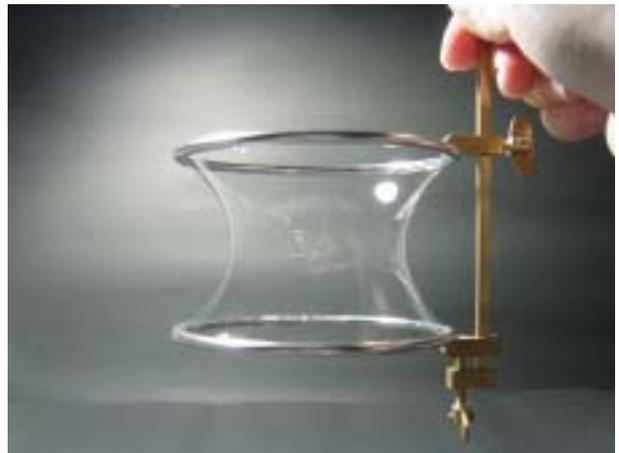
写真1、Catenoid Membrane
