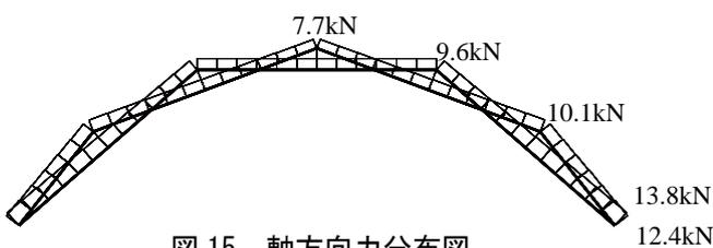
図 15 軸方向力分布図
