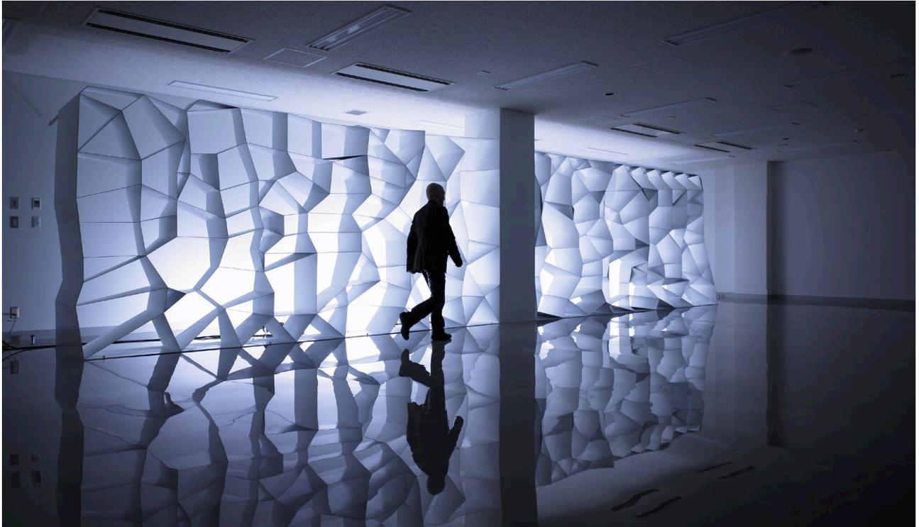
この壁面家具は、工法・構造上の条件を満たす変化のある形態になっている。初期値として節点（ノード）の開始位置と密度（最大・最小節点数）、節点間距離、接続角度の許容値を定め、節点が決められた許容範囲内で新しい位置に移動・増殖する。構造上の制約は、部材長と厚さで与えられている。各節点は与えられた条件に対して変化し、形態は入力条件により収斂、振動、消失する。この計算は、極座標の空間表記方法で行われており、設計者は「Super eye」と呼んでいる。
