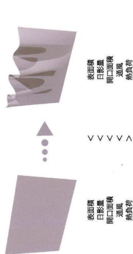
■フラットな壁は太陽の光を直接受け、室内に光や熱を通す。表面積の大きな壁は多くの日影が生まれ、熱量の低下や採光面積の増加をご周辺環境に適した建築が可能となります。
