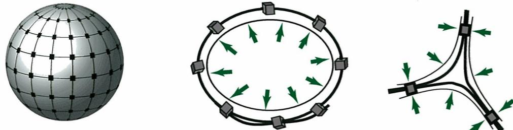
ゴム素材の球体にスペーサーを取り付けたワイヤーを巻きつけ、1つのセルを構成する。
