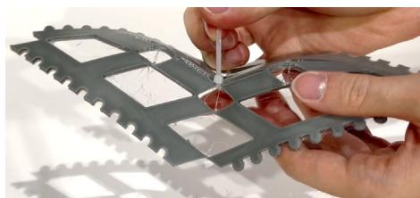
結束バンドを用いて中央の2点を結び曲面ユニットを生成する。
