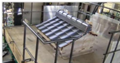
ガイドライン工法で施工した切妻屋根を、鉄筋6階建ビルの屋根を想定し、東日本大震災と同等の震動（約4分間）で耐震性を検証。この結果、棟の崩壊や瓦の脱落が認められず、巨大地震に対する安全性が証明されました。
