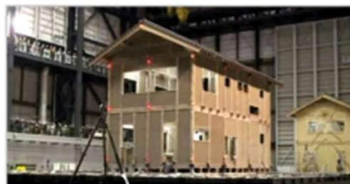
『伝統的木造軸組構法住宅の耐震性能検証実験』が（財）日本住宅・木材技術センターと独立行政法人 防災科学技術研究所との共同研究として実施。実物大住宅の性能検証振動台実験で、ガイドライン工法で施工した屋根瓦に損傷は認められませんでした。
