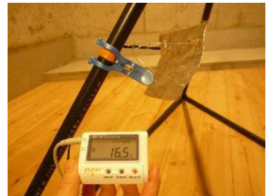
温度計をフレームに設置した状態(写真)
