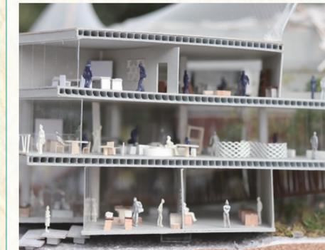
建築全体を浮かせることで、台地に沿み出してくる風を遮断せず、サンクチュアリの森、けんちくないぶまで、そのまま取り入れる。浮かせることで一面に土壌面が露出し、スラブ下は飼育生物の隠れ場になる。暗所を好む昆虫などの生息地、動物の通り道にもなる。
