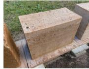
土のみのブロックは上層が雨などで土が流され、砂利が露わになっている。石灰を混ぜたものは比較的表層の削れや傷は見られないが、下層のほうが緑がかっているのがわかる。
