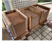
今回は上写真の左から、三井の土のみ/石灰/石灰+セメント/黄さば土、と種類ごとに版築ブロックを試作。表層や風化の経過を観察する。
