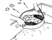
採ってきた土と砂はふるいにかけて大きい石や落ち葉を取り除く。土、砂、川砂利を水を加えながら混ぜていく。
