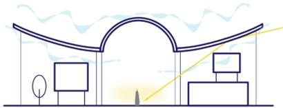
屋根がウインドキャッチャーとなり、屋根を伝って風がアーケード内へと入り込み、抜けていく。太陽の光が屋根の内側を反射し、通りを明るく照らす。
