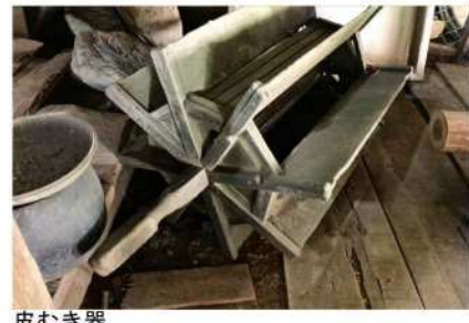
皮むき器 中に干し根菜を入れて両側の棒を川線に設置する。川の流れて中の野菜が回転し、木にあたり皮がむける。皮が木に流れて実だけが残る。
