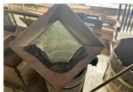
シュノーケル 木の桶のところに噛みモリで魚を突いて捕獲していた。外枠は木でできていて、ガラス部分から水中を覗く。
