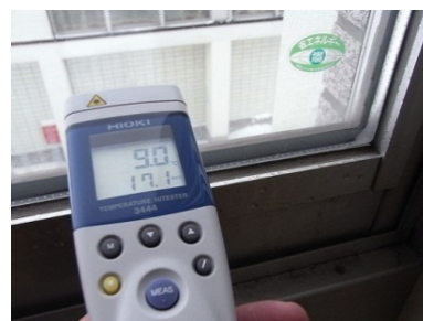
図1 放射温度計で窓面温度を測る（写真は冬）
