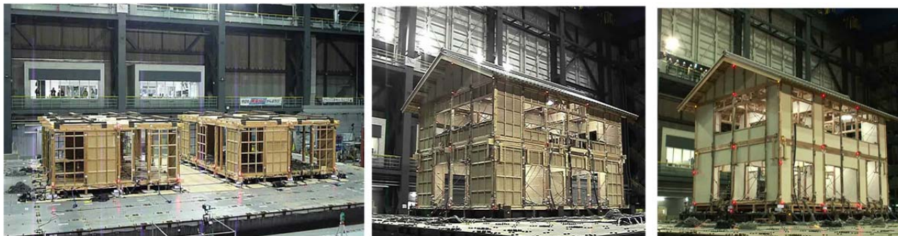
写真 5-1 2010 年度実大振動台実験(試験体 Nos. 1&2、試験体 No. 3、試験体 No. 4) 1) 独立行政法人防災科学技術研究所の実大三次元震動破壊実験施設(Eーディフェンス)を用いた。
