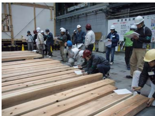
図 8-1 木材の品質を近代技術で計測された数値と大工の経験知との比較検討作業
